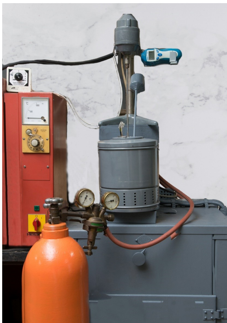
Слика 2. Уређај за вртложно ливење развијен на Техничком факултету у Бору
